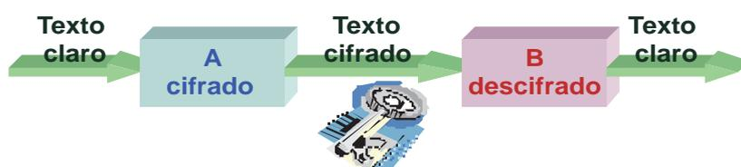
Figura 5. Proceso de cifrado y descifrado
